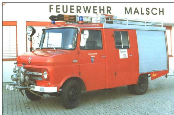
**Fahrzeugbezeichnung:** Löschgruppenfahrzeug LF 8 nach DIN 14 530
